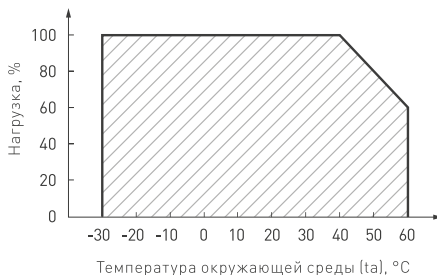
Рис. 2. Максимальная допустимая нагрузка, % от мощности источника
